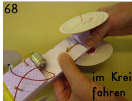
Im Kreis fahren Der Werklehrer Andi Bühlmann hat uns eine Anleitung geschickt, wie man die Achse so umbauen kann, dass das Fahrzeug einen Kreis fährt. Das Hartschaumstück ist dazu schräg zerschnitten worden und mit einem Gummi so fixiert, dass man es durch Drehen in einen anderen Winkel bringen kann.
