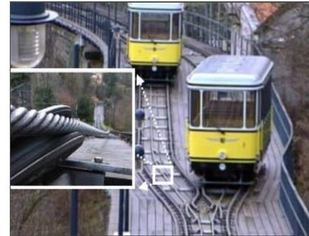
Pour ce funiculaire la cabine du haut est tirée par le câble enroulé pendant que l'autre descend.. Le câble est activé et réglé depuis en haut ( la station de montagne). Le poids de la cabine qui descend aide à ce que la cabine montante soit tirée. Sur l'image au milieu, on peut voir l'endroit où les voies sont doublées pour faire croiser les cabines. Plus à ce sujet sur Lexi-TV.
