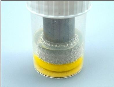
Ausdruck der chemischen Reaktionen sind die Bildung von Bläschen an der Aluminiumhülle, das riechen von Gasen und leichte Verfärbungen am Aluminium und im Salzwasser.
