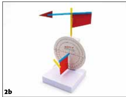
2b ... als Halterung für die beweglichen Windplatten beim Windmesser ...
